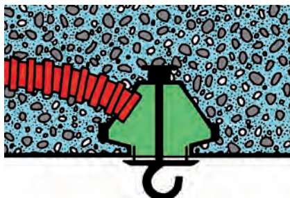
Obr. 8 Stropní krabice se svítidlovým hákem
