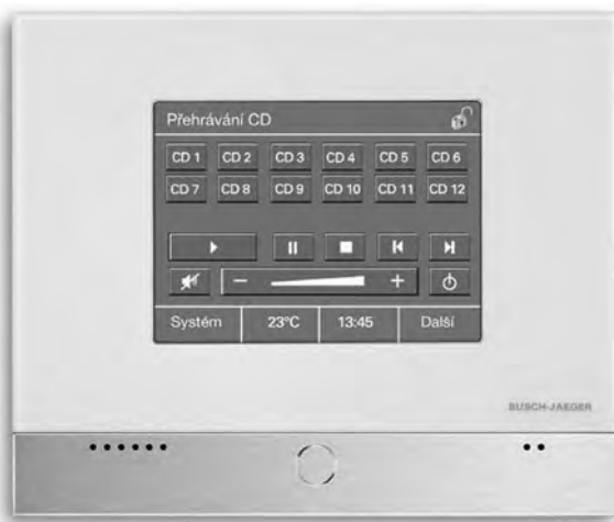
Obr. 99 Příklad zobrazení ovládání CD přehrávače na dotykovém panelu v systémové KNX instalaci
